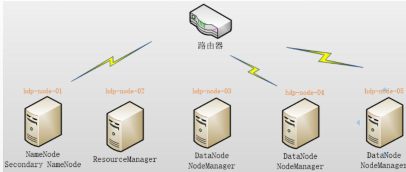
所谓集群，就是一组通过网络互联的计算机，集群中的每一台计算机称作一个节点，Hadoop集群搭建就是在这个物理集群之上安装部署Hadoop相关的软件，然后对外提供大数据存储和分析等相关服务。
